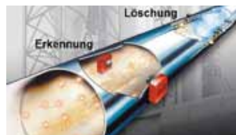
Beispielabbildung einer Funkenerkennung und -löschung
